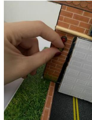
11. Colocamos los leds en los huecos del frente del prototipo, en el superior colocamos el led rojo en el cual el ánodo esta conectado al pin 3, mientras que el cátodo se conecta a GND del Arduino, por otro lado, el pin amarillo se coloca en hueco inferior donde el ánodo del led se conecta al pin 2 mientras que el cátodo al GND del Arduino.
