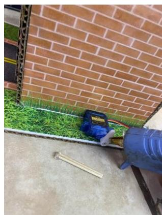
8. Colocamos el Micro Servomotor (SG90) en la parte inferior del prototipo y lo conectamos al Arduino, GND del servomotor se conecta a tierra en el Arduino, mientras que la potencia se conecta al Arduino en 5V y la señal (PWM) se conecta al pin 5 en el Arduino).
