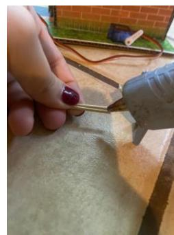
9. Pegamos un palito en el Micro Servomotor (SG90) que de igual manera nos servirá de palanca.
