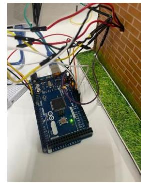
12. Colocamos el Sensor de distancia Ultrasónico en la parte superior del portón del garaje y pasamos los cables por un hueco en la parte superior para conectarlos al Arduino, donde el pin VCC del sensor se conecta a 5V en el Arduino, luego el pin TRIG se conecta al pin 8, el pin ECHO va conectado al pin 9 de Arduino mientras que tierra va en el GND del Arduino.
