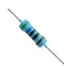
Valor de resistencia: Depende de la aplicación y del LED o componente que se esté protegiendo.
