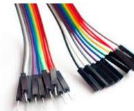
Tipo: Varía según la aplicación, comúnmente se utilizan cables de cobre estañado con aislamiento de PVC.
