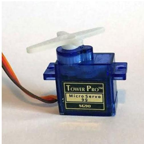
El ángulo de giro, en este caso nos permite hacer un barrido entre -90º y 90º. Lo que viene a ser un ángulo de giro de 180º. Aunque el servo puede moverse con una resolución de más de 1 grado, este es el máximo de resolución que vamos a conseguir debido a la limitación de la señal PWM que es capaz de generar Arduino UNO.
